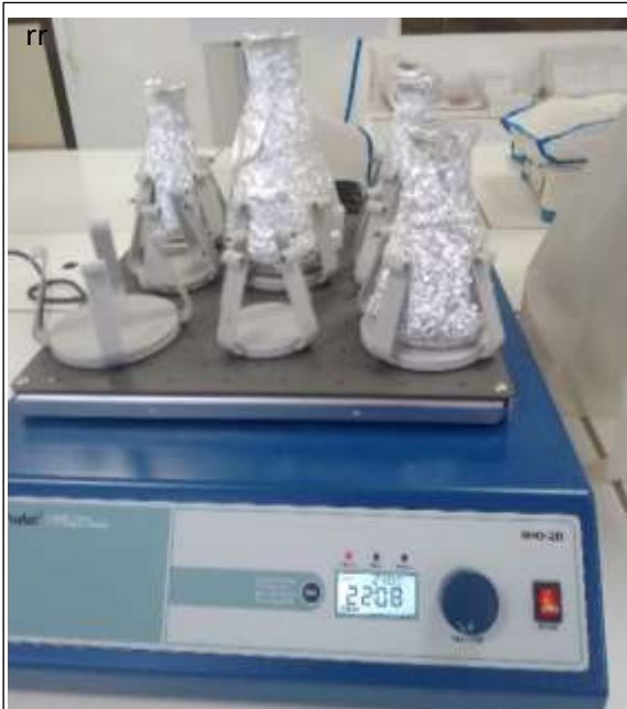
Macération durant 24 heures sous agitation orbitale à température ambiante.
