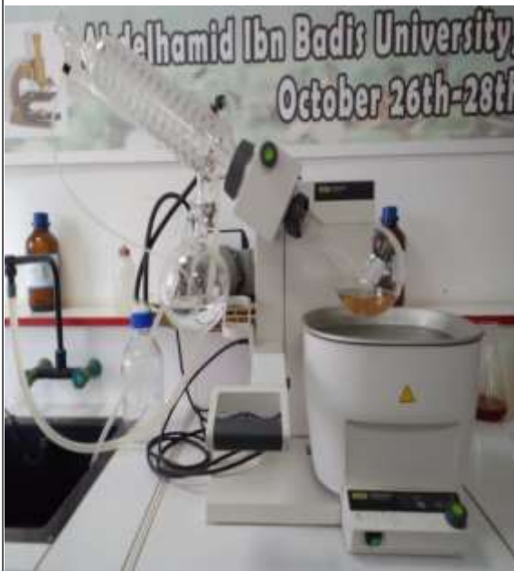
Evaporation à sec à 45°C par évaporateur rotatif
