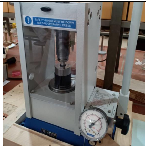
4. Presse (10 tonnes) pour la confection d'une pastille
