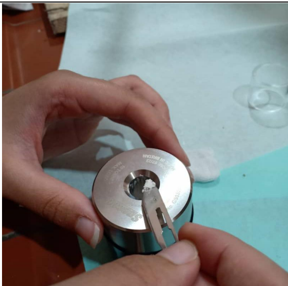
3. Transfert du mélange pulvérisé dans un moule en acier spécial.
