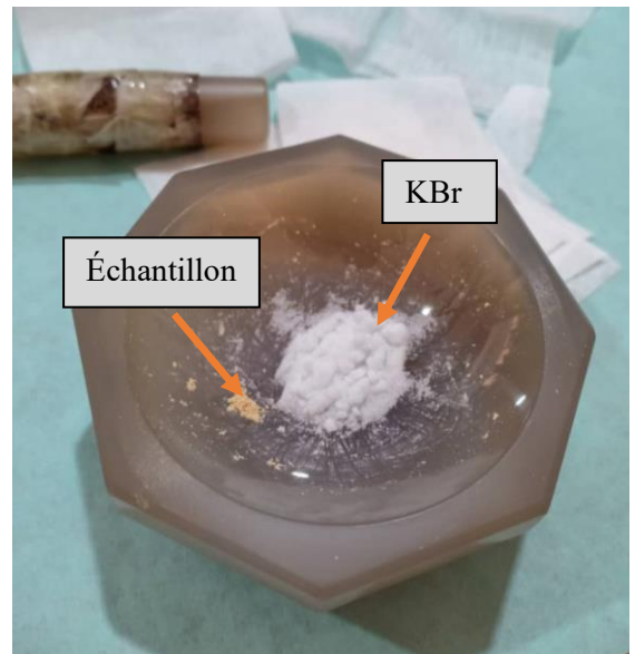
2. Dilution l'échantillon 0,5 à 3% en ajoutant KBr pur.
