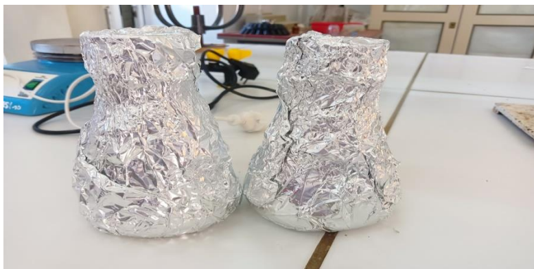
Figure16: recouverte les deux mélange par péprier aluminium (photo personnel)
