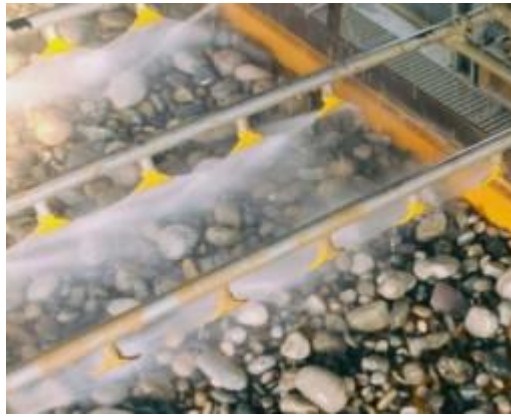
Figure 14 : lavage des granulats
