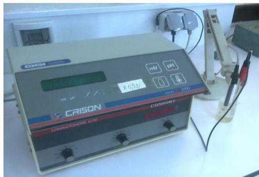
**Figure 8.** Le pH mètre utilisé pour mesurer le pH du milieu de culture
