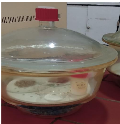
Dessiccateur pour conserver le KBr à l'abri de l'humidité
