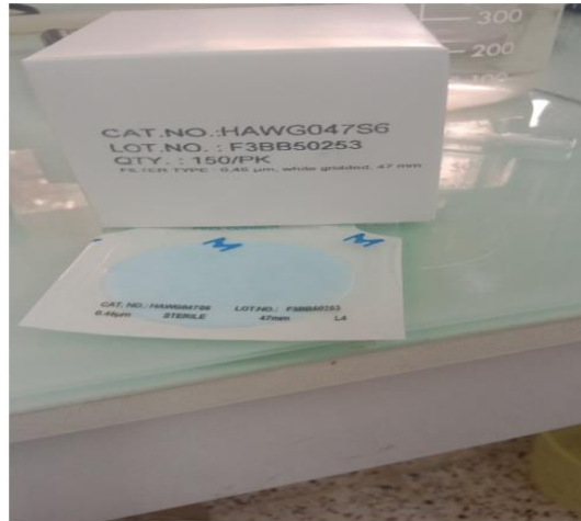
Photo. IV.32. Membrane de porosité 0.45 µm (Laboratoire ADE Mostaganem, 2024)
