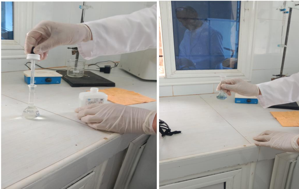
Photo .IV.24. Apparition d'une coloration bleue en présence de phosphate (Laboratoire STEP Sidi Lakhdar, 2024)
