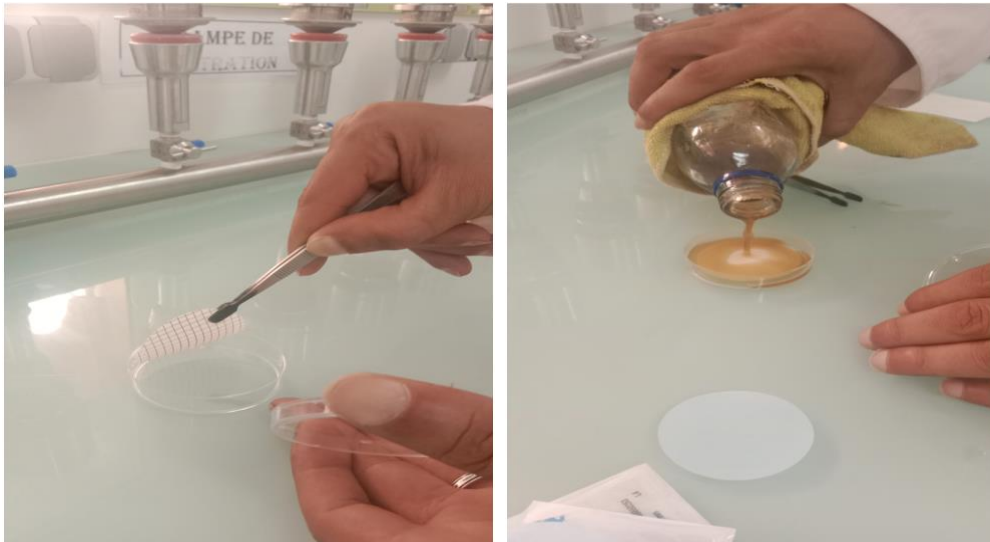
Photo. IV.52. Emplacement de la membrane à l'envers au dessus de la gélose viande de foie (Laboratoire ADE Mostaganem, 2024)
