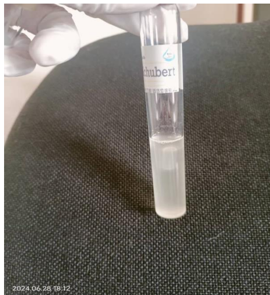
Photo. IV.42. Trouble de couleur et présence du gaz dans la cloche de Durham. (Laboratoire ADE Mostaganem, 2024)
