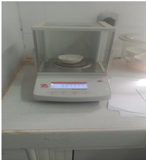
Photo .IV.11. Balance magnétique (Mesurer la masse m1) (Laboratoire STEP Sidi Lakhdar, 2024)
