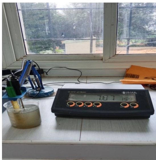
Photo .IV.5. pH mètre (laboratoire STEP Sidi Lakhdar, 2024)
