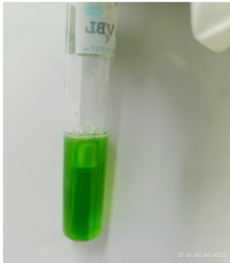
Photo.IV.38. Trouble de couleur et présence du gaz dans la cloche de Durham. (Laboratoire ADE Mostaganem, 2024)
