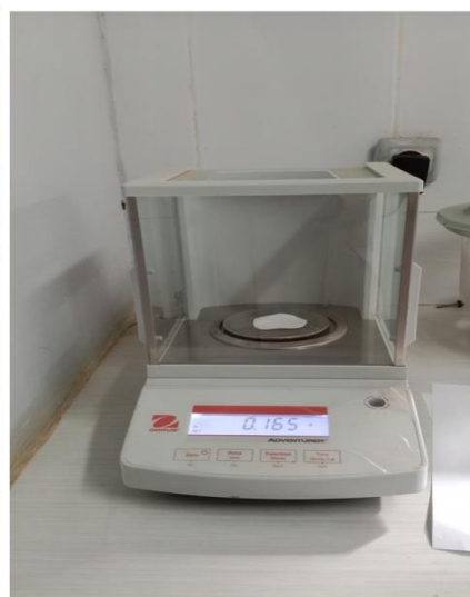
Photo .IV.9.Balance magnétique (Mesurer le poids de filtre m0)
