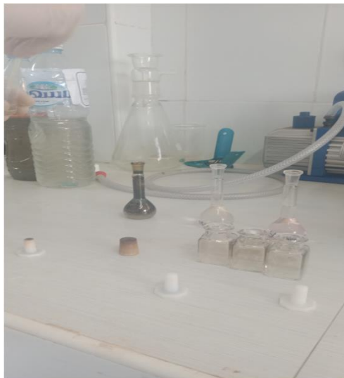
Photo .IV.22. Apparition d'une coloration rose en présence de Nitrite (Laboratoire STEP Sidi Lakhdar, 2024)
