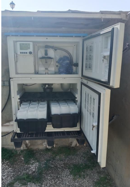
Photo. IV.2. Le système de réfrigération des prélèvements (STEP Sidi Ali, 2024)
