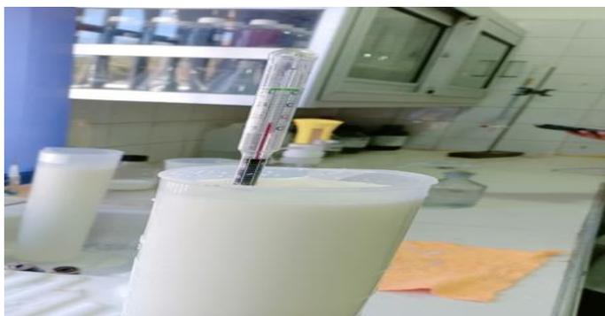
Figure5 : détermination de la densité des différents
