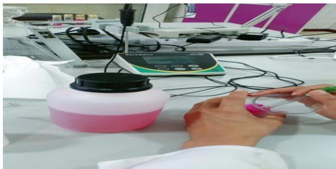
Figure 4: détermination du pH des différents laits
