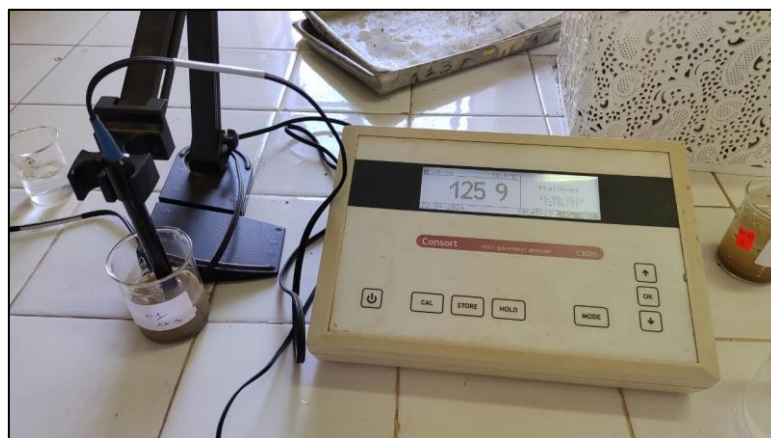
Figure 13. Mesure de la conductivité électrique du sol par le conductimètre.
