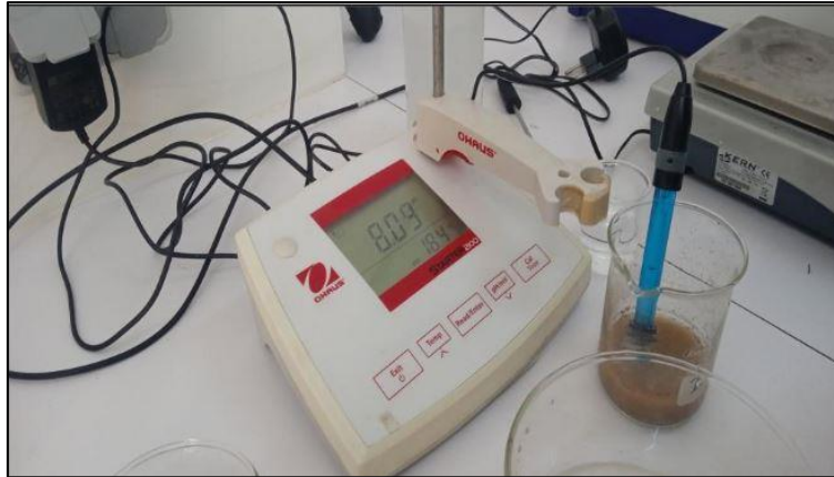
Figure 12. Mesure du pH d'un échantillon de sol à l'aide d'un pH-mètre
