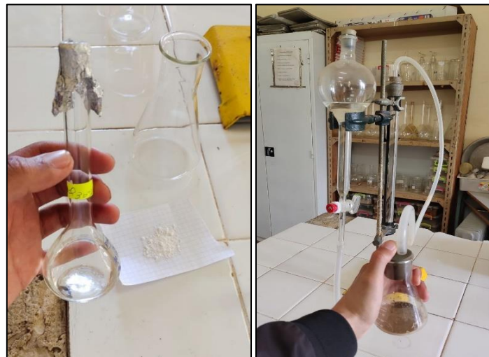
Figure 14. Dosage du calcaire total.
