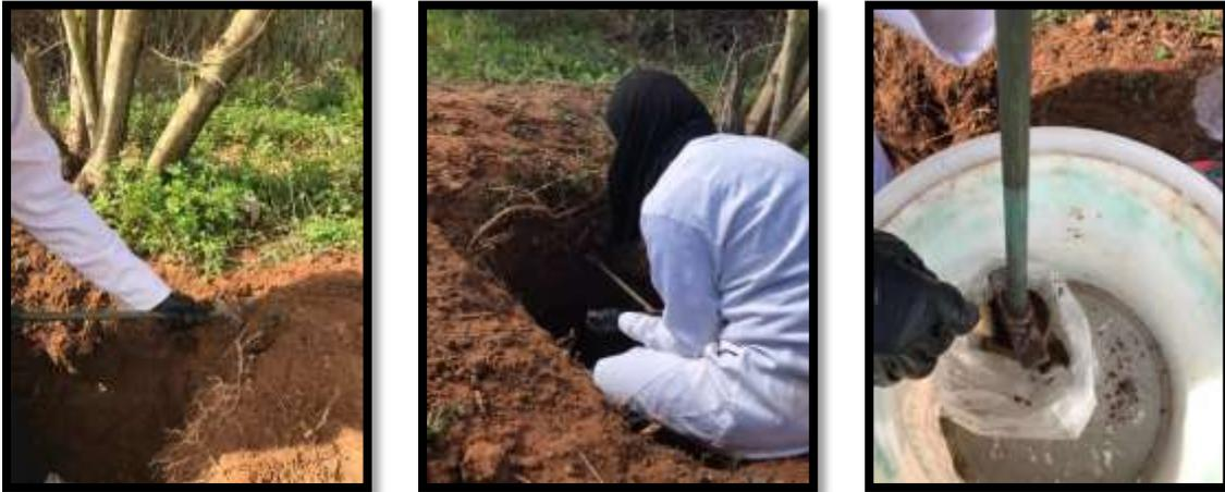
**Photo 2:** Mesure de la densité apparente à l'aide d'un cylindre calibré (Cliché Besseghier et Bouziane, 2024).
