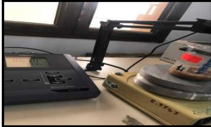
**Photo 6:** Mesure du pH d'un échantillon de sol à l'aide d'un pH mètre
