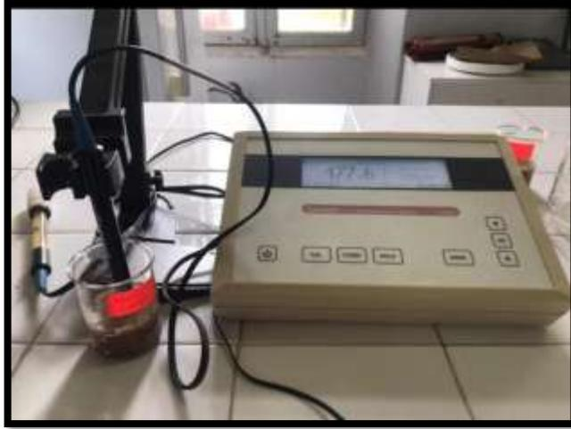
**Photo 7 :** Mesure de la conductivité électrique du sol par le conductimètre
