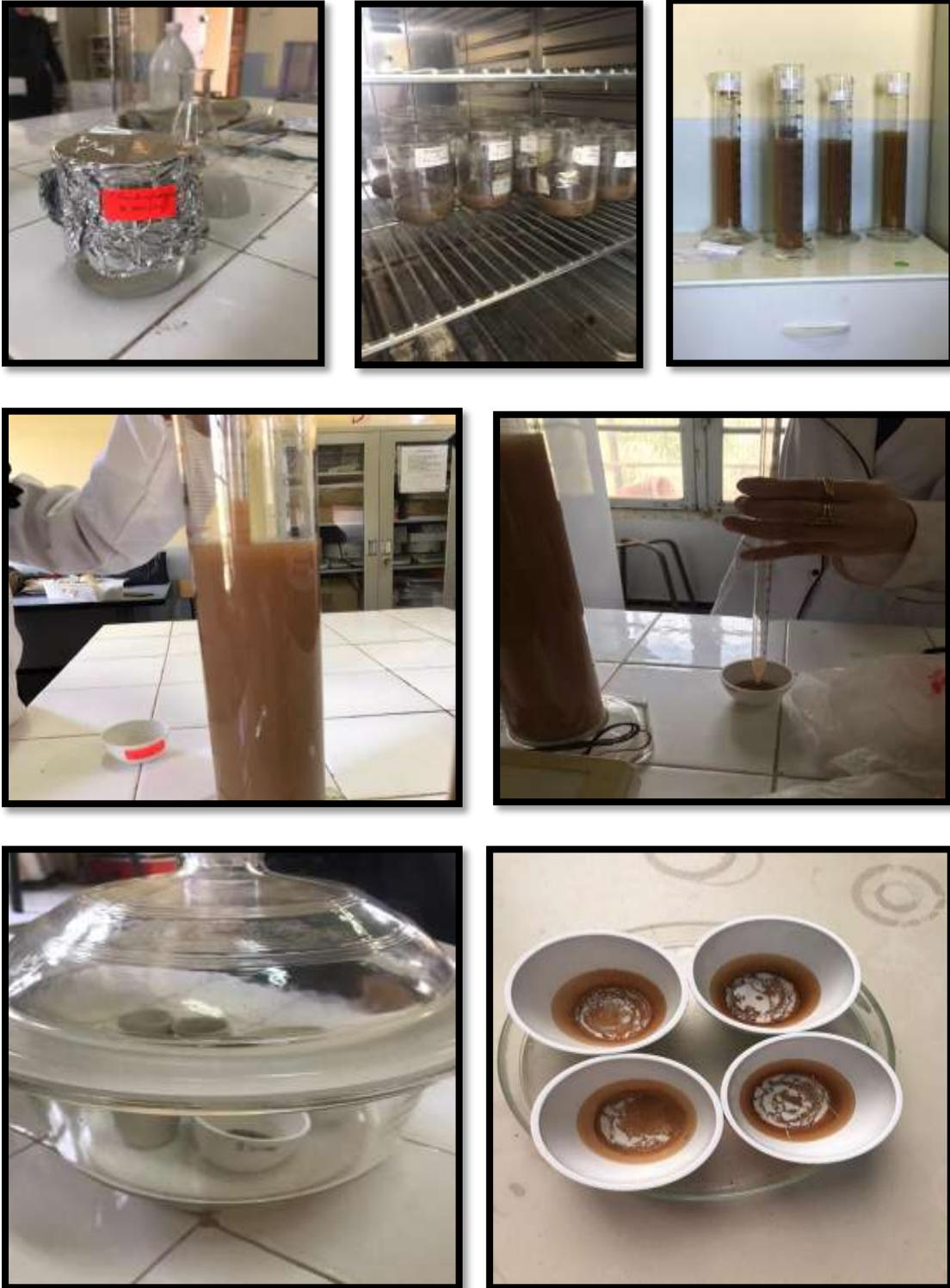
**Photo 5:** Analyse granulométrique par la méthode de la pipette de Robinson
