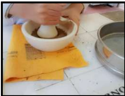
Photo 3: Broyage et tamisage des échantillons de sol (Cliché Kecir, 2024).
