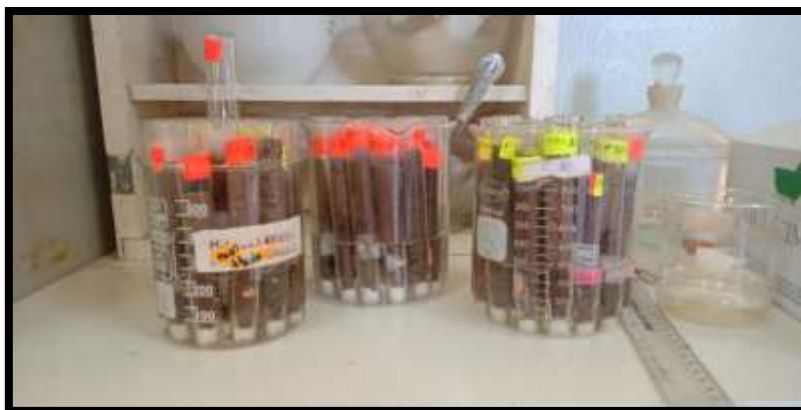
Photo 22: Mesure de la rétention en eau (Cliché Kecir, 2024).
