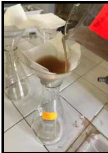
Photo 8 : Dosage du calcaire actif (Cliché Kecir, 2024).
