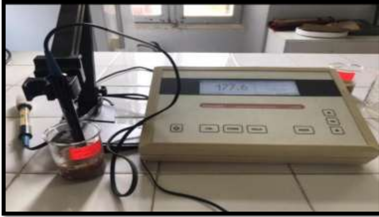
Photo 6 : Mesure de la conductivité électrique du sol par le conductimètre (Cliché Kecir, 2024).
