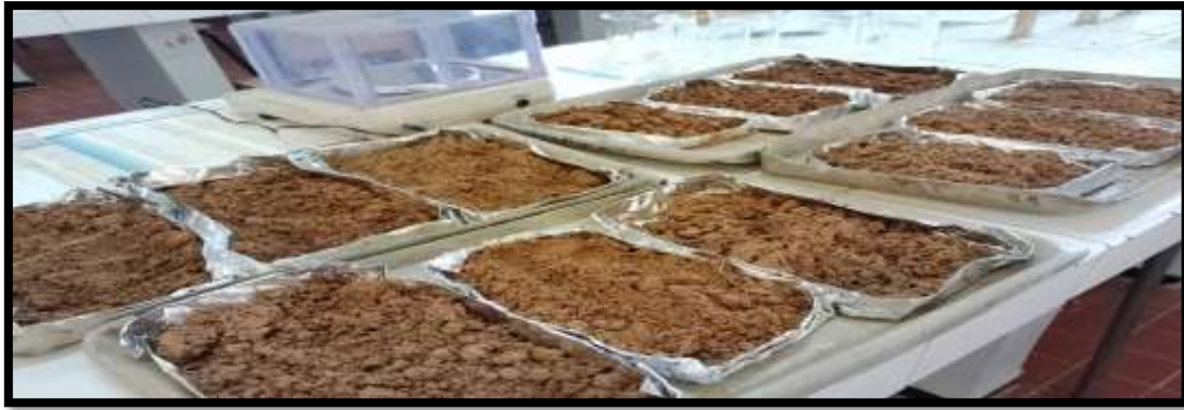
Photo 2: Séchage des échantillons de sol (Cliché Kecir, 2024).
