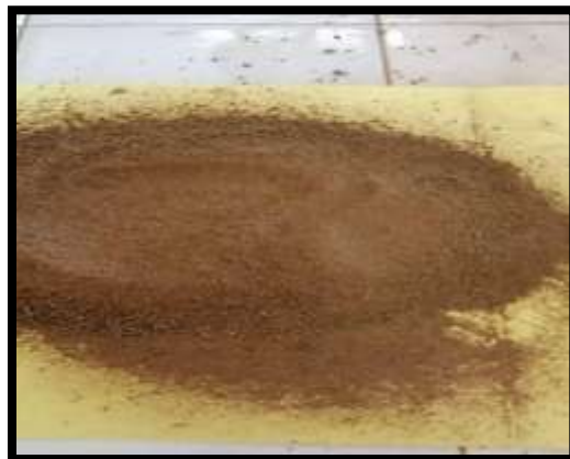
Photo 3: Broyage et tamisage des échantillons de sol (Cliché Kecir, 2024).
