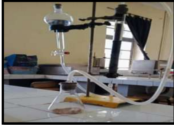
Photo 7 : Dosage du calcaire total (Cliché Kecir, 2024).
