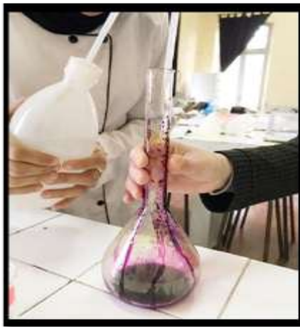
Photo 7 : Dosage du calcaire total (Cliché Kecir, 2024).
