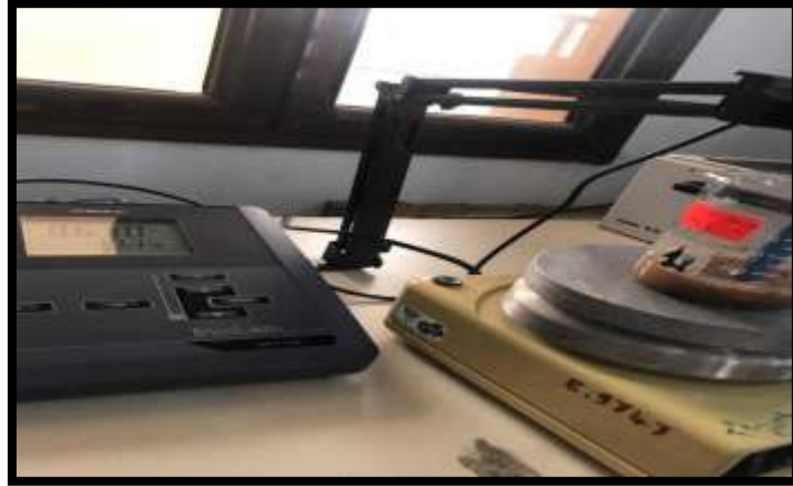
Photo 5: Mesure du pH d'un échantillon de sol à l'aide d'un pH mètre (Cliché Kecir, 2024).
