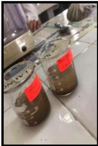
Photo 8 : Dosage du calcaire actif (Cliché Kecir, 2024).
