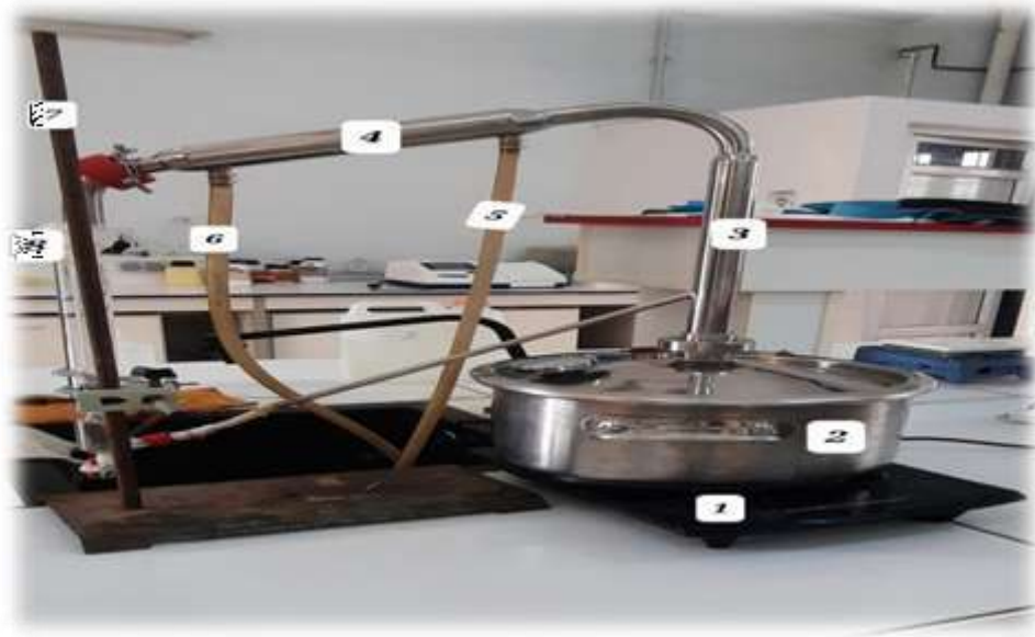
Figure 18 : Composants de distillation à la vapeur ;- 1 : plaque chauffante, 2 : cocotte-minute , 3 : condensateur, 4 : réfrigérant, 5 : sortie de l'eau , 6 : entrée de l'eau, 7 : support, 8 : tube gradué (Originale,2024)
