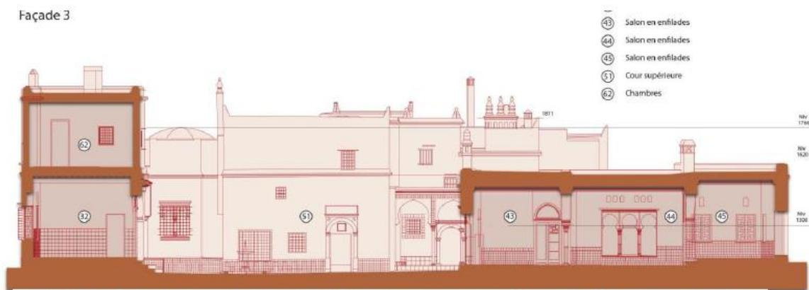
Image 31 Coupe sur les salles en enfilades et le logement du conservateur 1930 passant par la cour supérieure.
