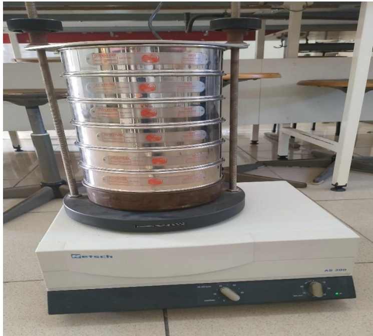
Figure 16: Montage de la série de tamis (allant de 2 mm jusqu'à <math><0.05\text{ mm}</math>) sur une tamiseuse mécanique
