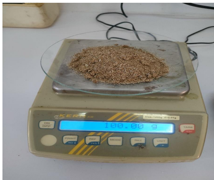
Figure 15: Pesage de 100 g du sédiment à l'aide d'une balance électronique précision de 0.01g
