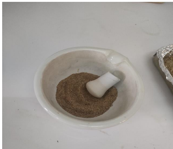
Figure 18: Broyage du sédiment
