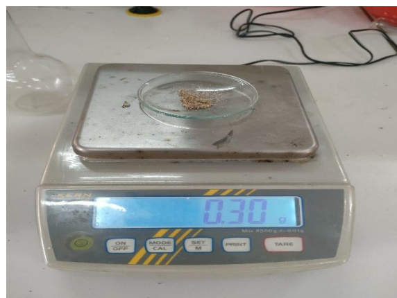
Figure 21: Pesage de 0.3 g du sédiment
