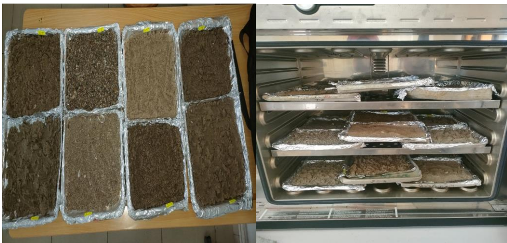
Figure 14: Préparation des échantillons de sédiments pour le séchage dans l'étuve à 105°C pendant 24 h.
