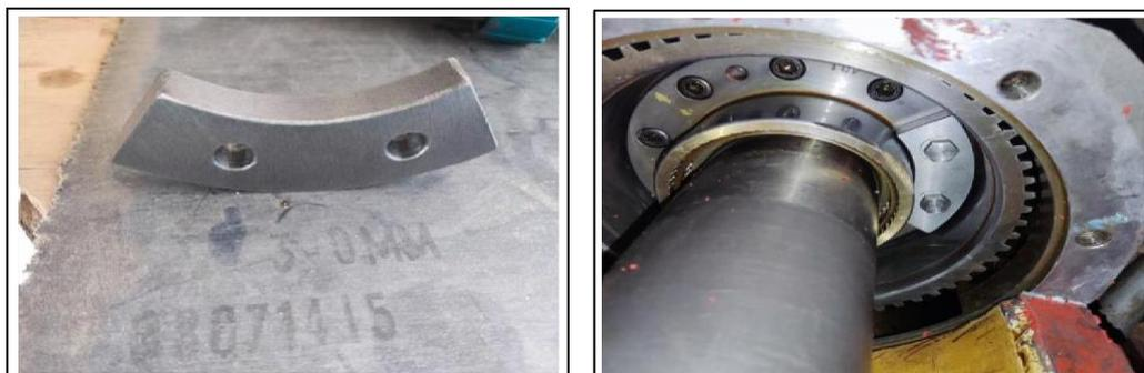
Figure IV.34 : présentation et installation de la masse de test 3 (234g) sur le rotor HP.
