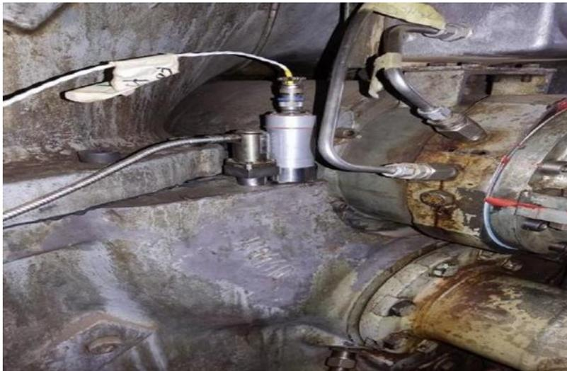
Figure III.10 : position du capteur de vibration et Key-phaser sur palier 1 de MS 3002
