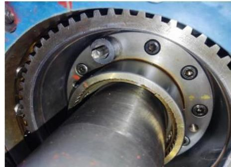
Figure IV.29 : présentation et installation de la masse de test 1 (114g) sur le rotor HP.
