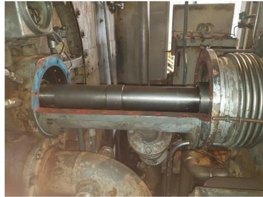
Figure IV.28 : Accouplement de rotor HP .
