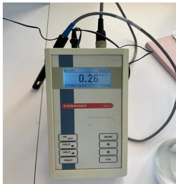
Figure 15 : Appareil conductimètre (mesure salinité, température et conductivité)
