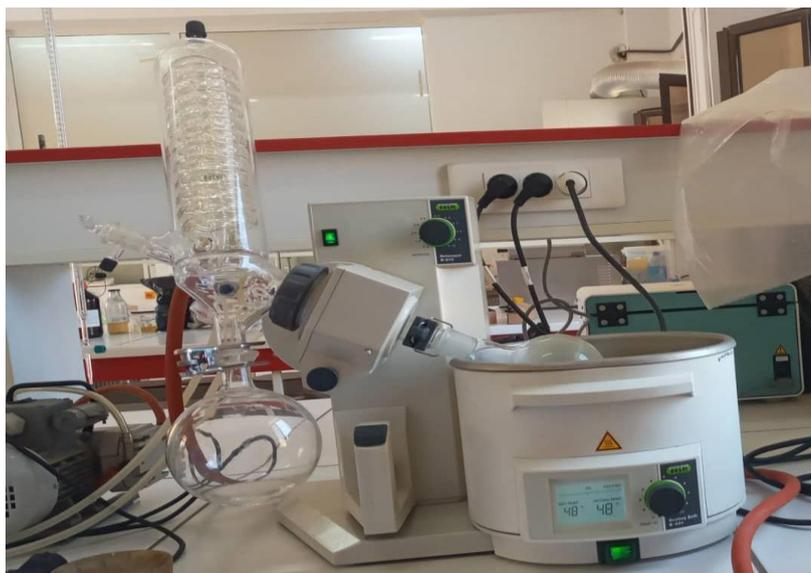
**Figure 31:** Montage de l'évaporateur rotatif de laboratoire (Said. khelifa ; 2024)
