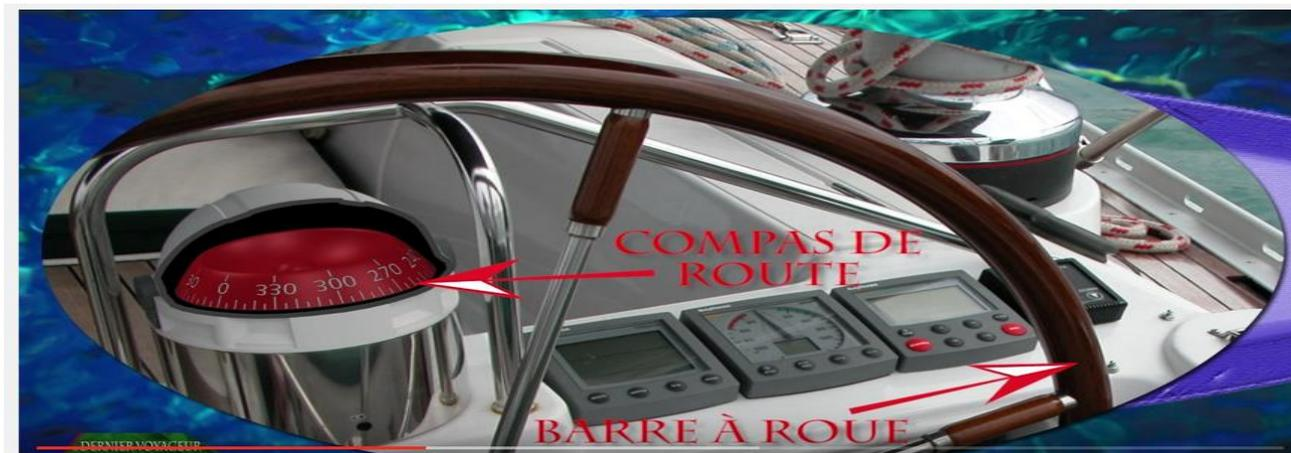
Fig. 9. Exemple de compas de route embarqué sur les bateaux de navigation.
