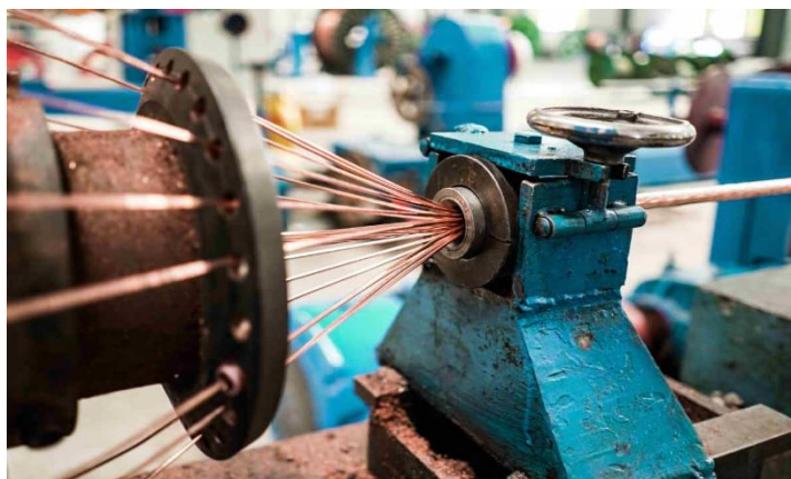
Figure : Assemblage des câbles électriques.
