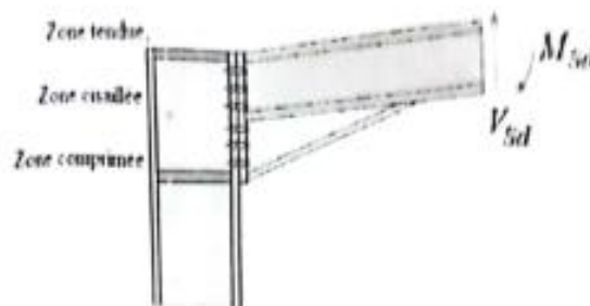
Figure : V.7. Vérification à la résistance de l'âme du poteau dans la zone tendue
