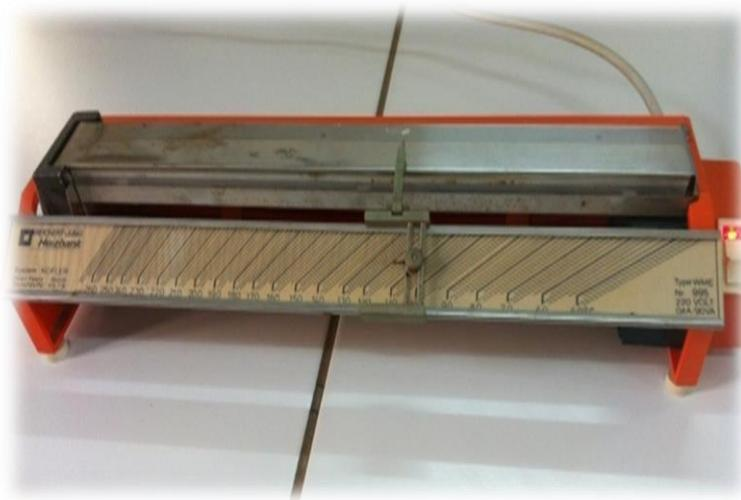
**Photo 8. L'appareil de banc de Koffler.**
