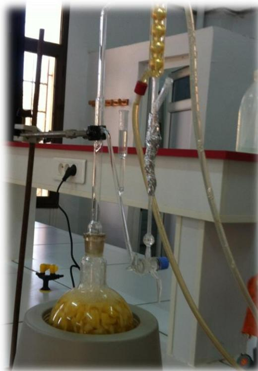
**Photo 2. Dispositif utilisé pour l'extraction de l'HE du citron**
