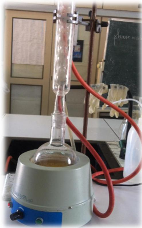
**Photo 4. Dispositif de chauffage à reflux.**
