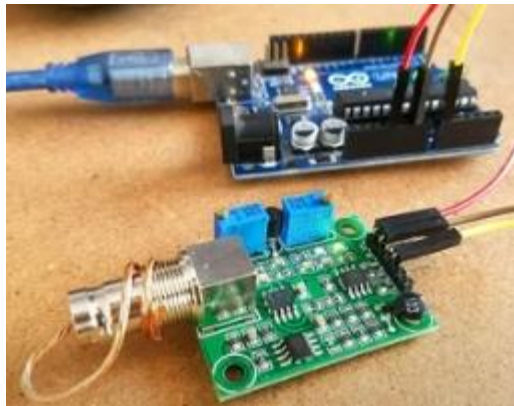
Figure III-1:Étalonnage du capteur de pH.
