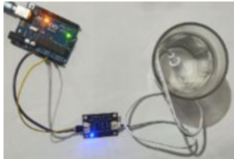
Figure III-7:Etalonnage du capteur de EC.
