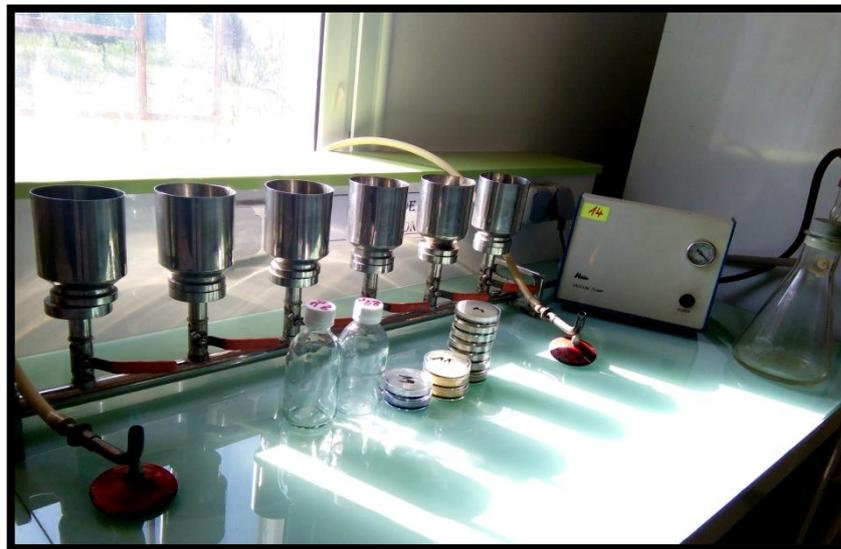
Figure 09 : Rampe de filtration. (Source : présent travail)
