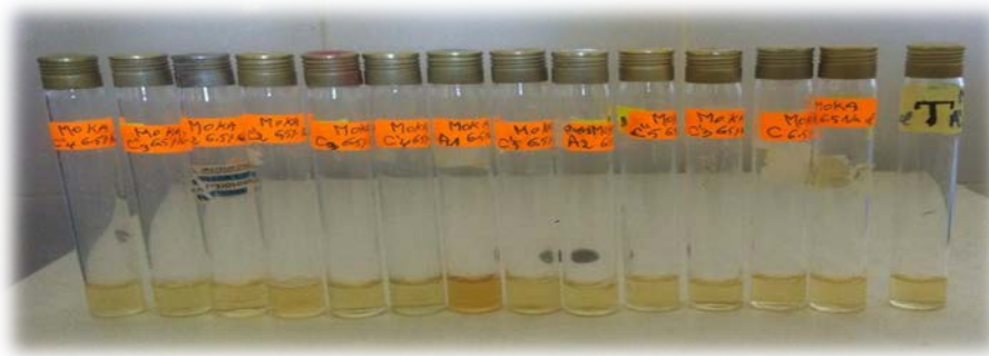
Figure 11 : Test de croissance sur milieu Naylor et Sharp après 48h à 30 °C
