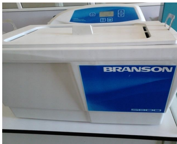
Figure n°10 : Sonicateur Modèle Branson utilisé pour avoir un extrait aromatique (Originale 2018).
