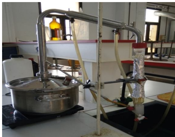
Figure n°12 : Dispositif d'extraction de l'huile essentielle (Originale 2018).
