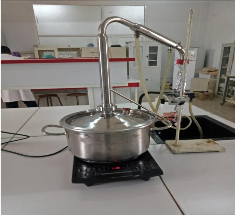
figure12: distillateur par entrainement à la vapeur
