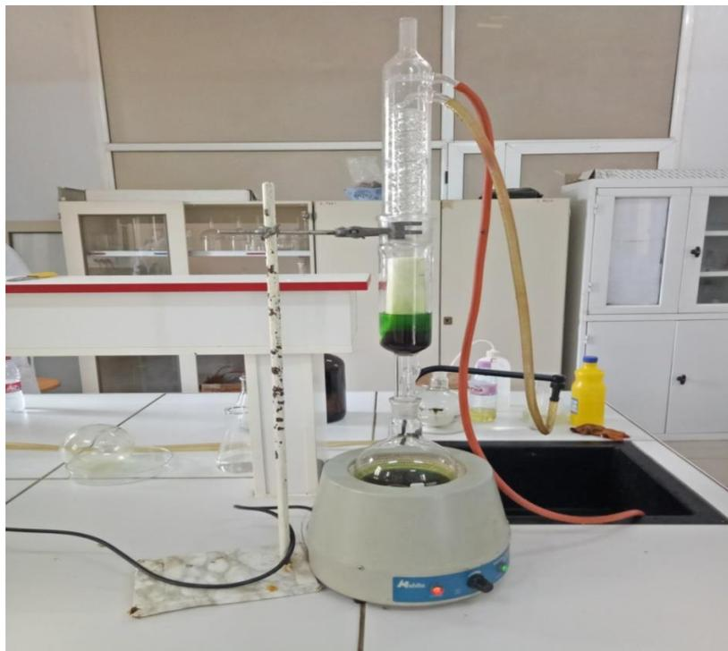
**Figure13:** Dispositif Soxhlet
