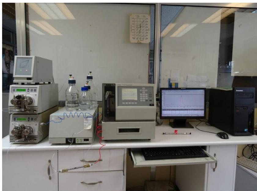
**Figure II-13:** Equipement HPLC utilisé.
