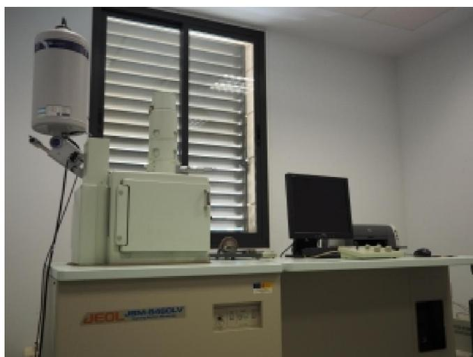
**Figure II-11 :** Microscope électronique à balayage.
