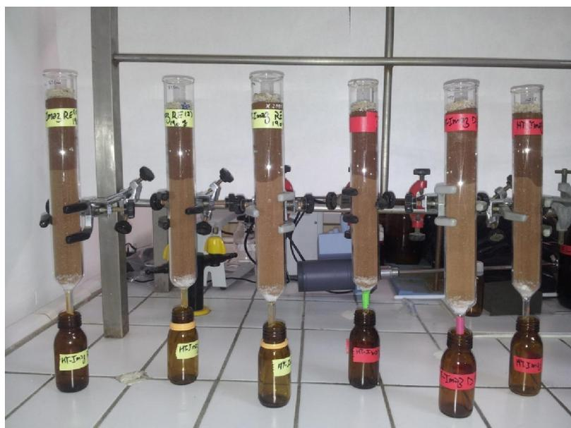
**Figure II-15** : Colonnes de sol utilisées pour l'étude de lixiviation des herbicides.
