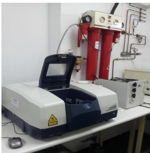
Figure II-10 : Spectroscopie JASCO FT/IR-6300 type A.
