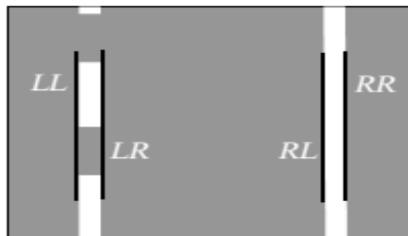
Figure II.10 : Limites des bords de la voie.
