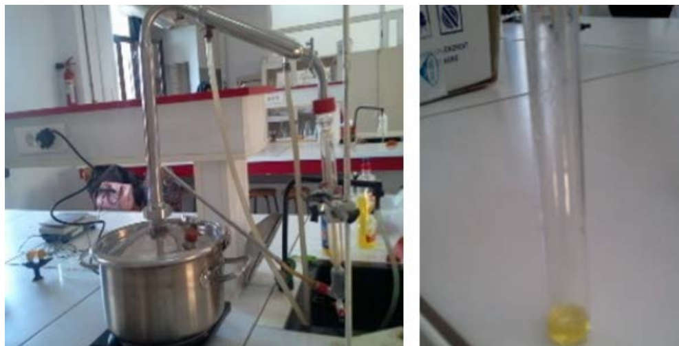
Figure 19 : Dispositif d'hydrodistillation des huiles essentielles.
