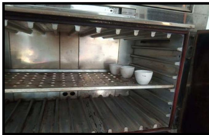
**Figure 11** : L'étuve avec les creusets.
