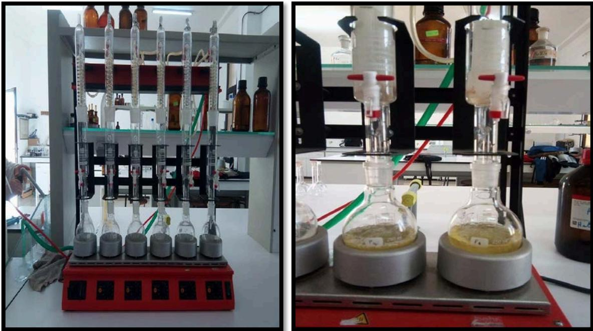
**Figure 15** : Appareil de Soxhlet pour l'extraction des lipides
