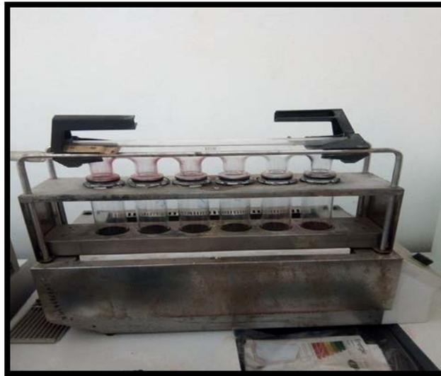
**Figure 12 :** Le digesteur (Appareil de minéralisation)
