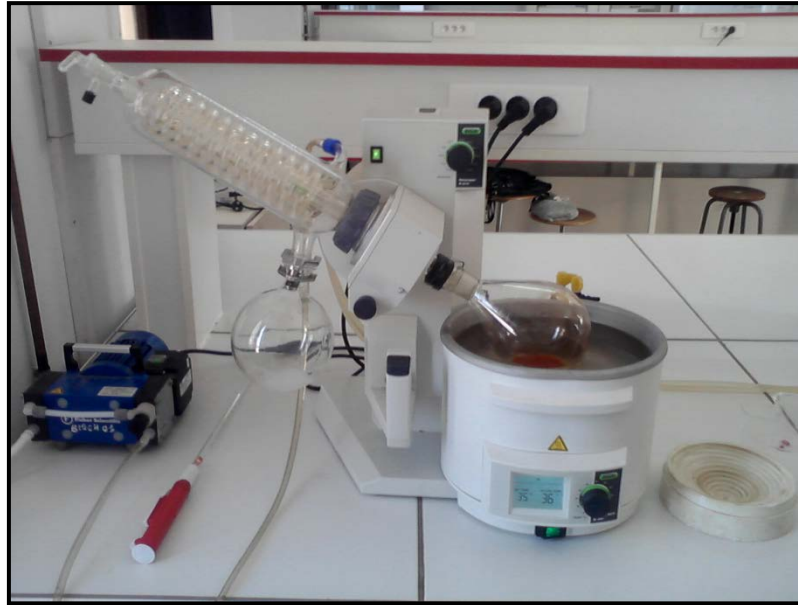
Figure 25 : l'appareil du rotavapor avec échantillon (les huiles)
