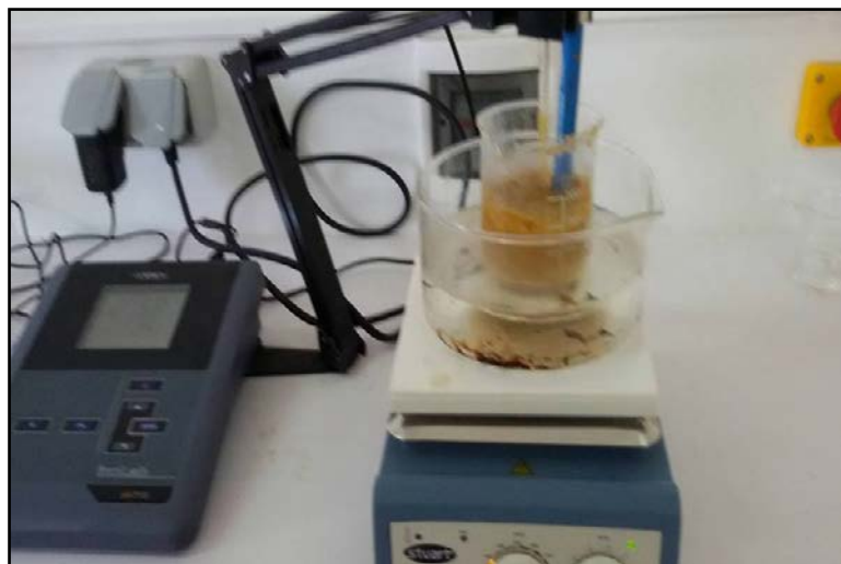
Figure 16 : montage de l'appareil pour hydrolyse enzymatique des coproduits de la crevette.
