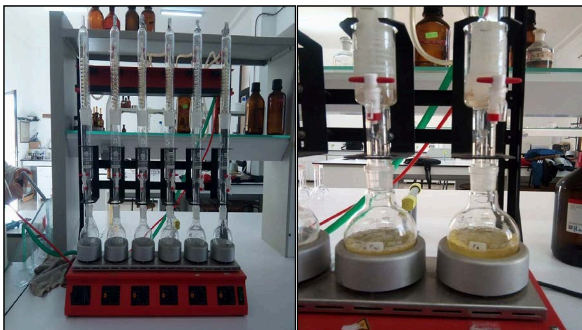
Figure 24 : Appareil de l'extraction de lipide par la méthode de Soxhlet
