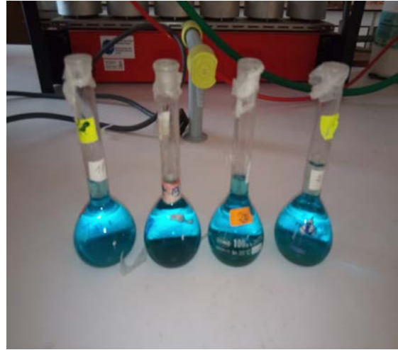
Figure 21 : Echantillon après la minéralisation, Préparé pour distillation.
