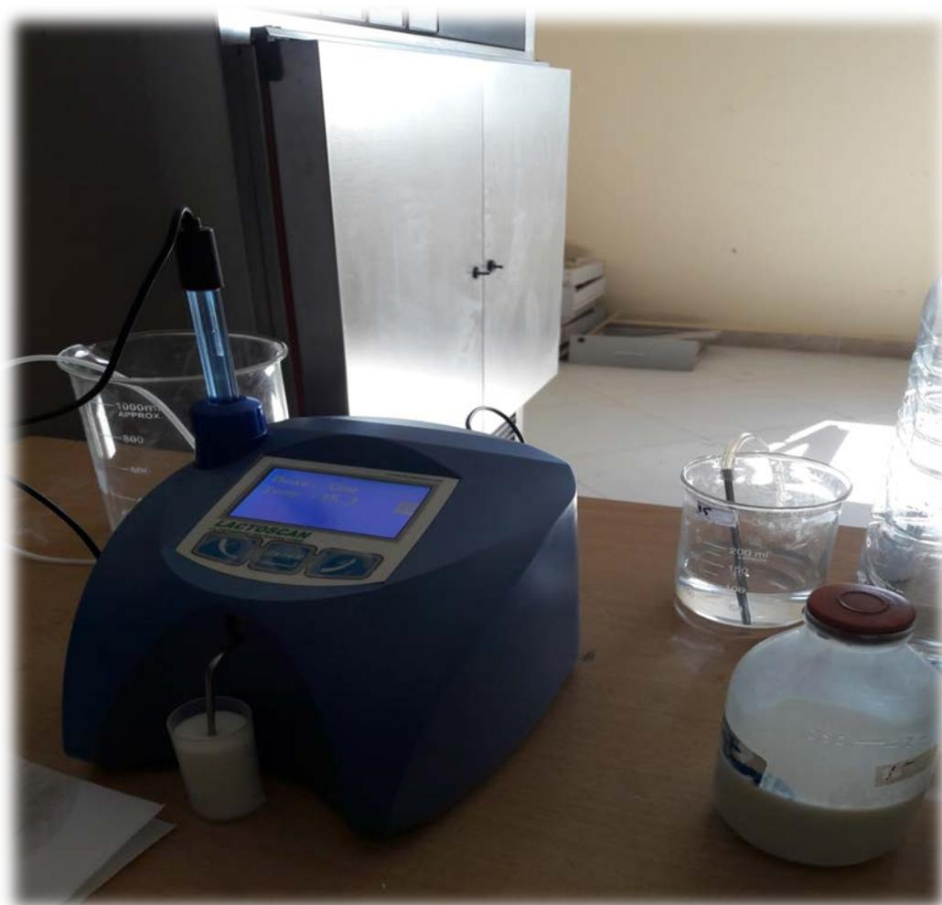
**Figure 10 : Le Lactoscan l'analyseur chimique moderne**
