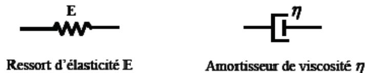
FIG 1 : Eléments rhéologiques usuels en viscoélasticité
