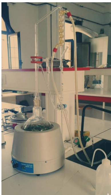
Figure 3 : Extraction d'huile essentielle par hydro distillation dans un appareil de type Clevenger ( originale , 2016)
