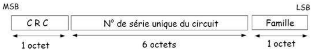
Figure II-7: L'adresse physique d'un circuit 1-Wire.
