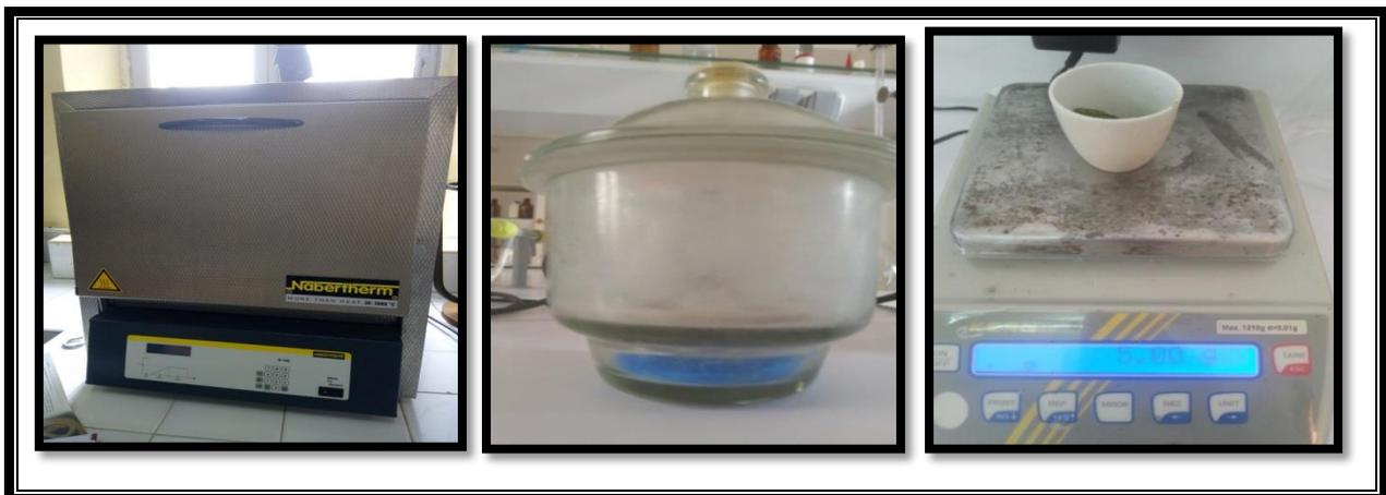
**Figure 28 :** appareillage des cendres brutes
