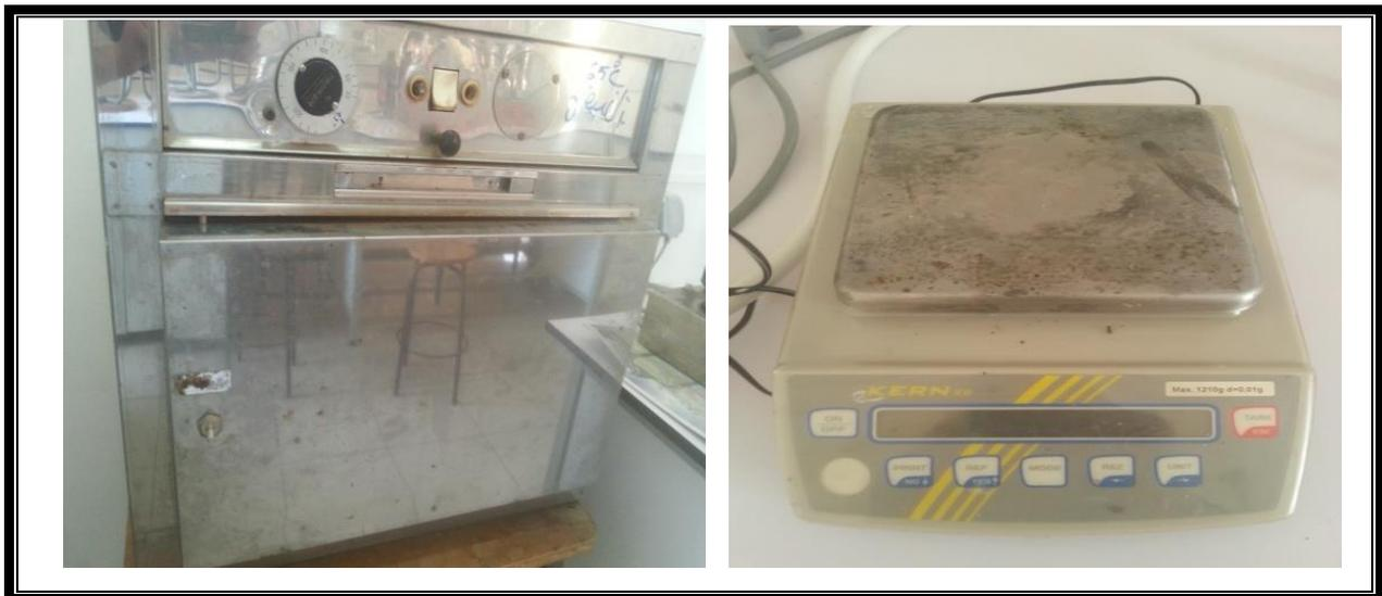
**A : Etuve électrique****B : Balance électrique****Figure 27 : Appareillage de La teneur en eau****5.1. Mode opératoire :**
