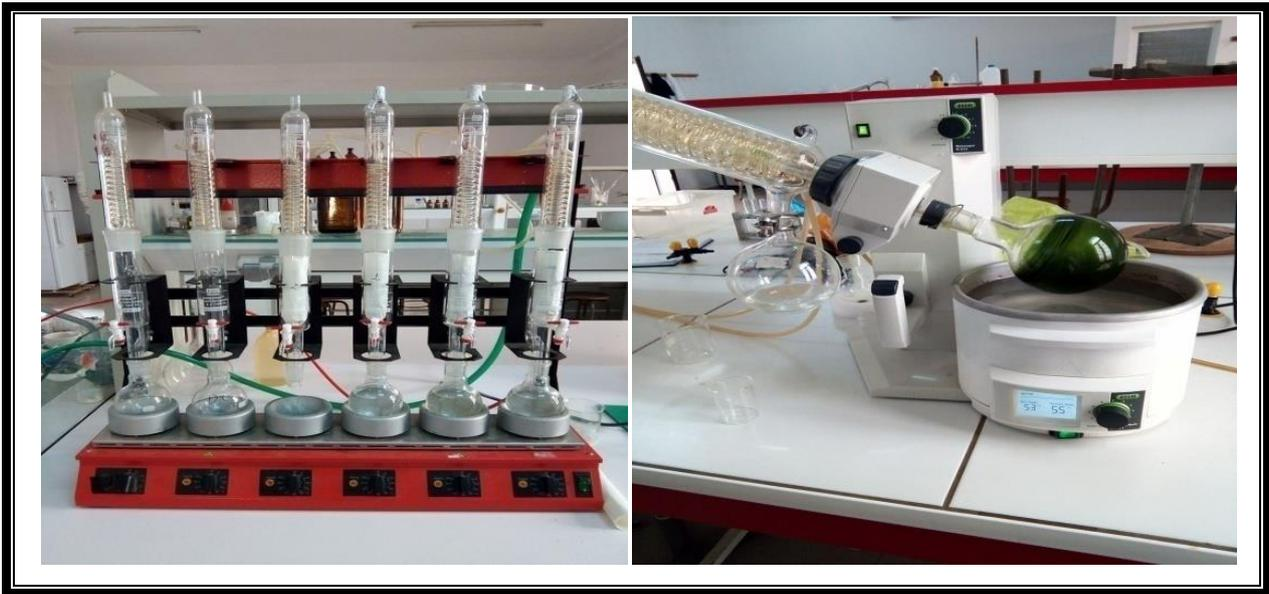
Figure 15 : Extracteur de Soxhlet
