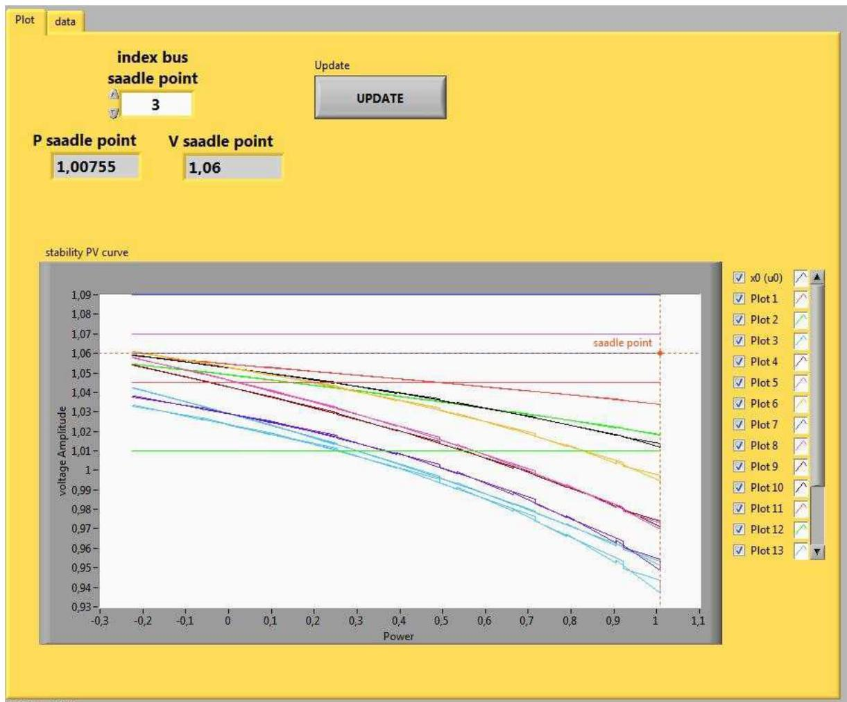
Figure (V.6) : l'Interface graphique du logiciel Labpower pour l'analyse de stabilité par la courbe PV.
