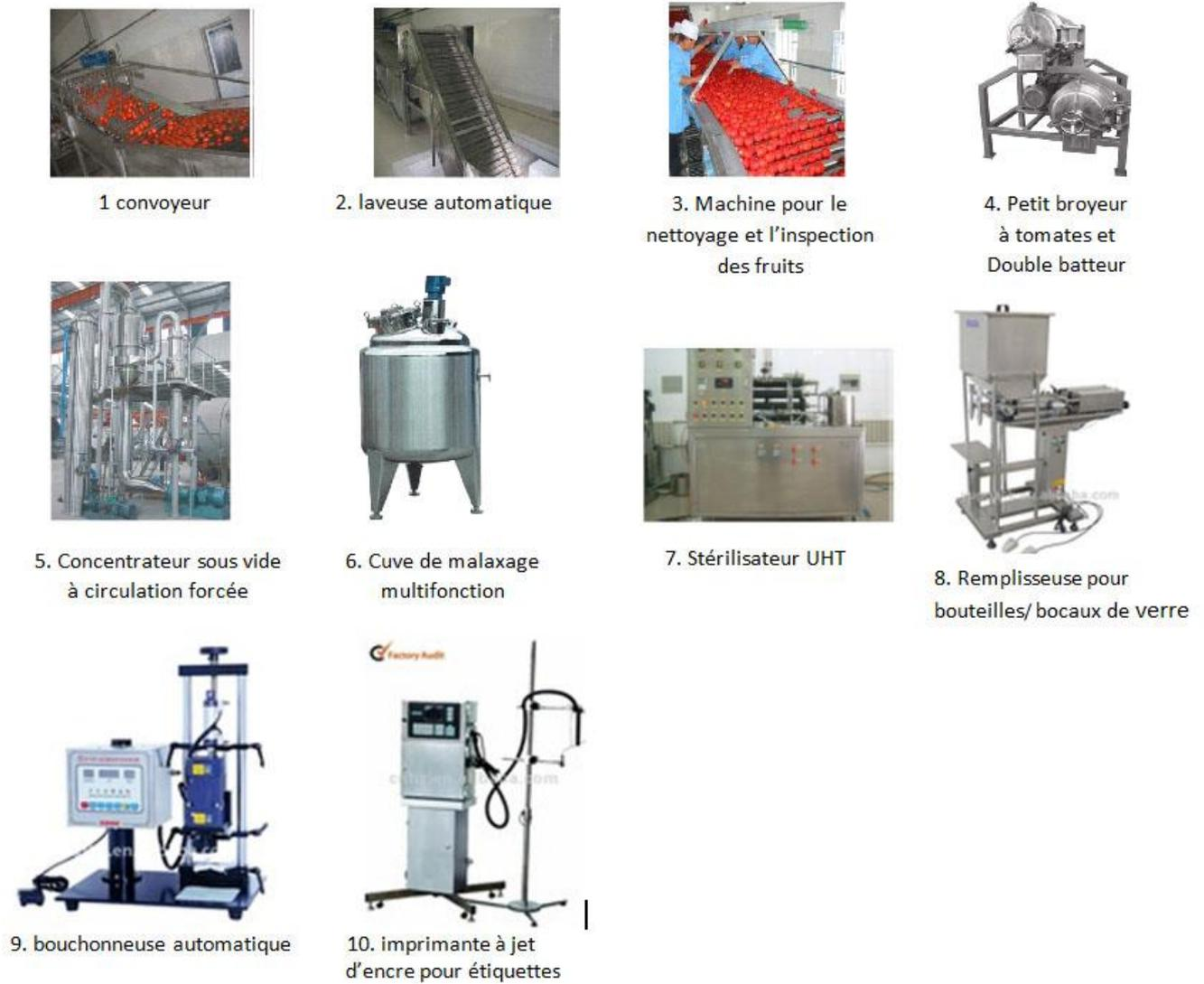
**Figure 04:** les différents équipements nécessaires pour la transformation de tomate concentrée
