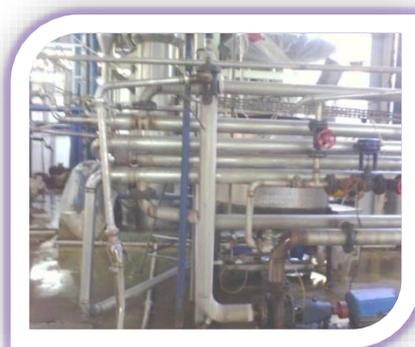
**Figure15** : Machine de pasteurisation
