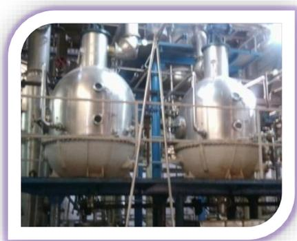
**Figure13** : Boules de cuisson
