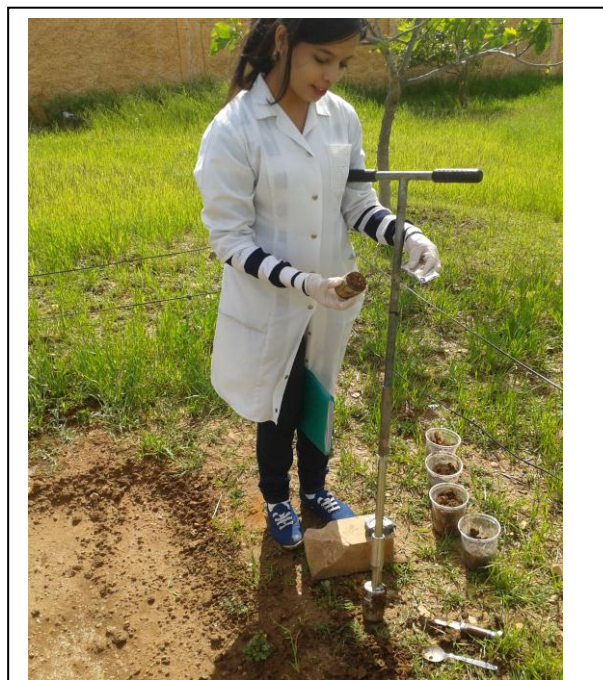
Prélèvement d'échantillons de sol à l'aide du cylindre calibré
