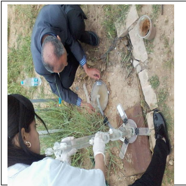
Installation de l'infiltromètre
