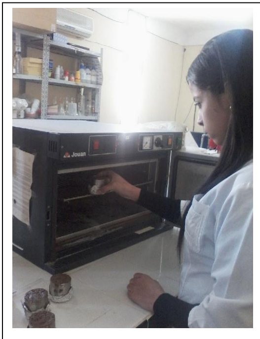
Séchage des échantillons de sol à l'étuve
