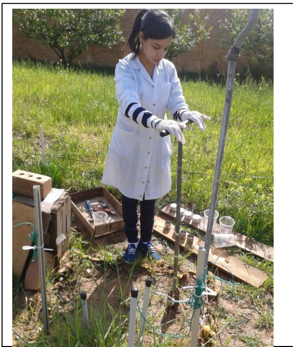
Prélèvement d'échantillons de sol à l'aide d'une tarière
