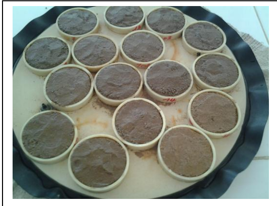
Saturation des échantillons pour déterminer les pF
