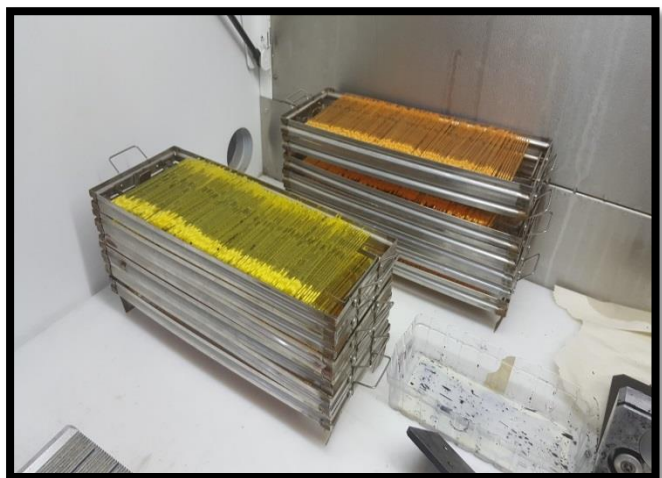
Figure 17 : les rampes de congélation.
