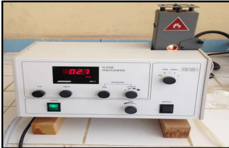
Figure35. La lecture par spectrophotométrie à flamme
