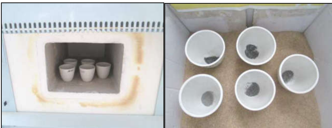
Figure 31. Creusets dans le four à moufle Figure32. Les échantillons après deux heures de calcination.
