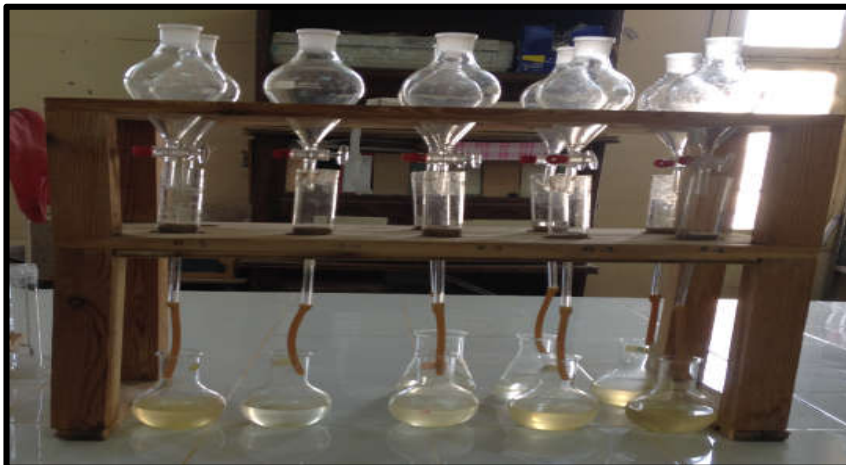
Figure 27. Dispositif de la capacité d'échange cationique (CEC).
