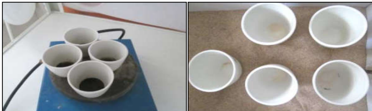
Figure 33. Les échantillons pendant l'évaporation. Figure 34. Les échantillons après une heure de calcination.
