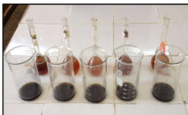
Figure 24. Dosage avec le sel de Mohr.
