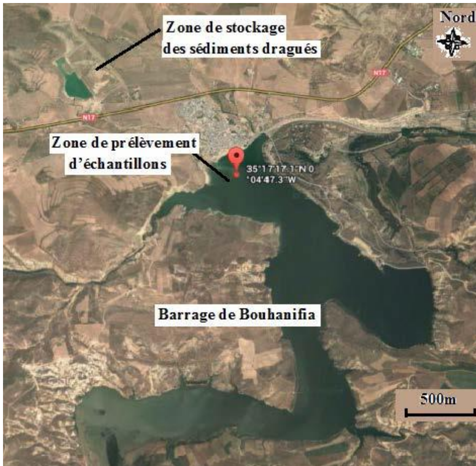
Figure 32. Situation géographique de l'emplacement des dragues dans la cuvette du barrage de Bouhanifia.
