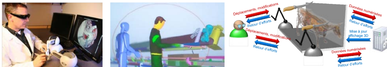
Fig. 17 : Exemples de systèmes de réalité virtuelle : en Immersion partielle avec lunette pour vision 3D et manettes à retour d'effort pour la formation de chirurgiens (à gauche), en Immersion totale avec génération d'un avatar 3D de l'opérateur réelle (au centre), ou en Immersion totale avec retour tactile d'efforts (projet en définition pour la formation d'opérateurs/bouchers – IUT Puy en Velay, IFP haute Loire, ADIV, ...)
