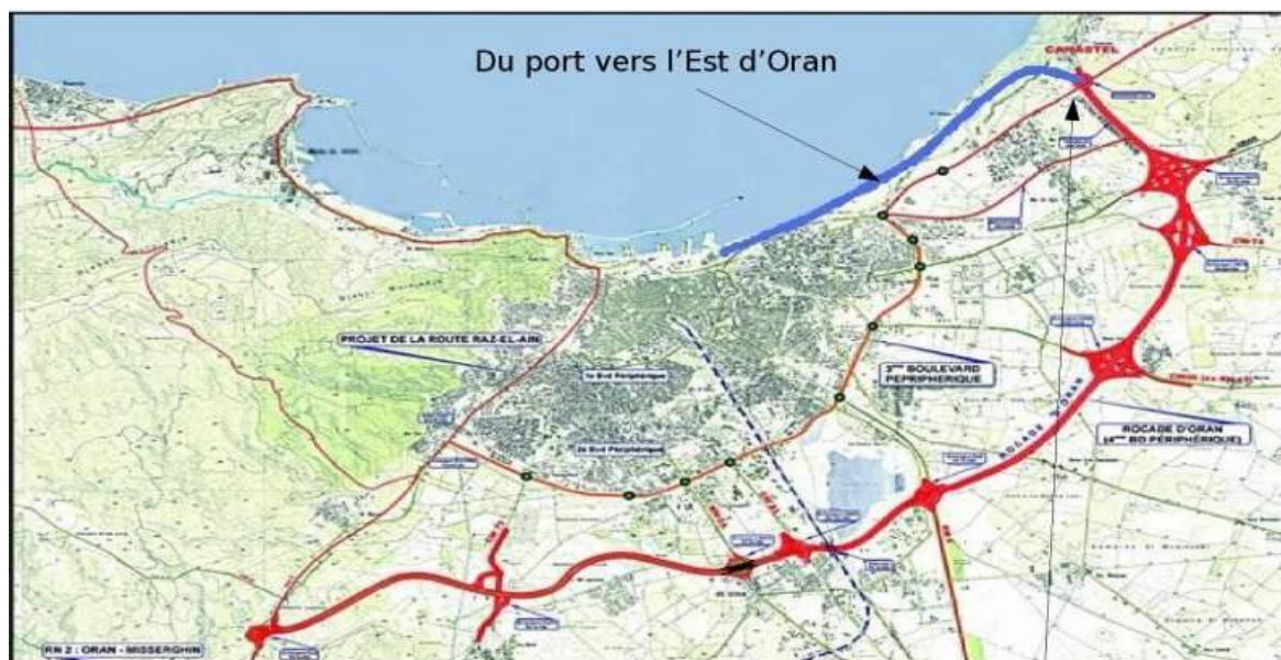
Figure 02 : la nouvelle route : Cette liaison autoroutière reliant le port d'Oran à l'autoroute Est-Ouest sur 26 kilomètres, dont la première tranche sur 8 kilomètres est en cours de réalisation en 2X3 voies. Selon une source proche du projet dont le maître d'ouvrage est l'Agence nationale des autoroutes (ANA).
