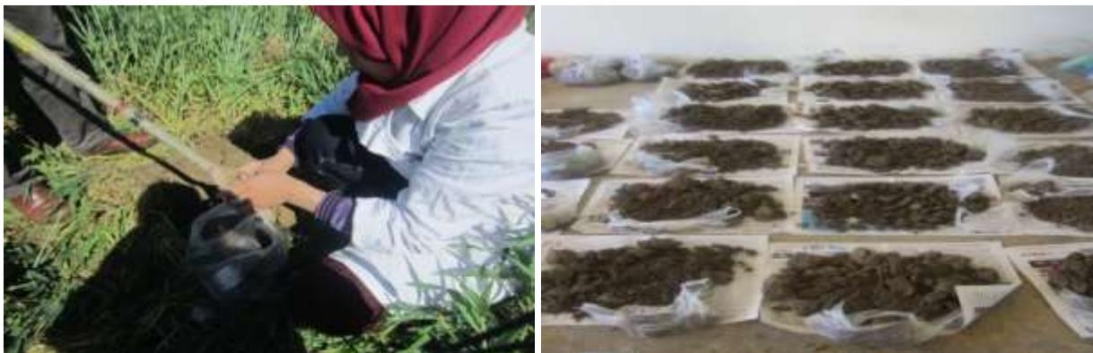
Photo 1 – Prélèvement des échantillons et séchage à l'air libre
