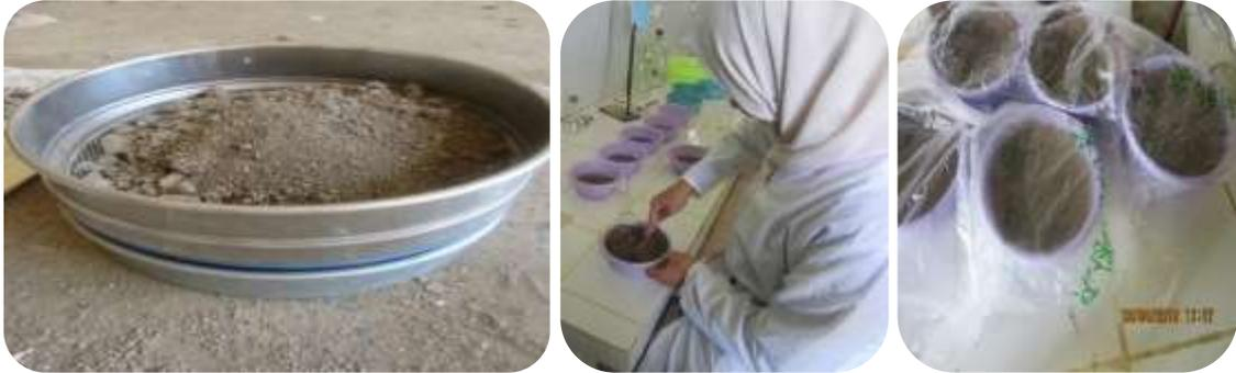
Photo 2 – Tamisage des échantillons à 2 mm et préparation de l'extrait de pâte saturée
