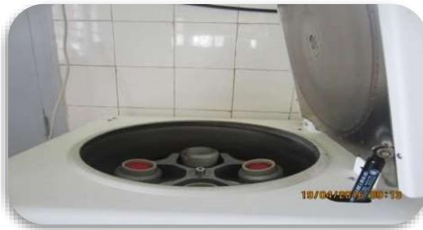
Photo 3 - Extraction de l'extrait de pâte saturée par centrifugation
