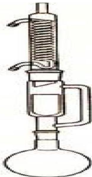
**Figure III.12:** Appareil de soxhlet [3].
