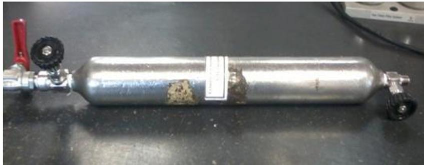
**Figure 23. Bombe d'échantillonnage de type "HOKE".**
