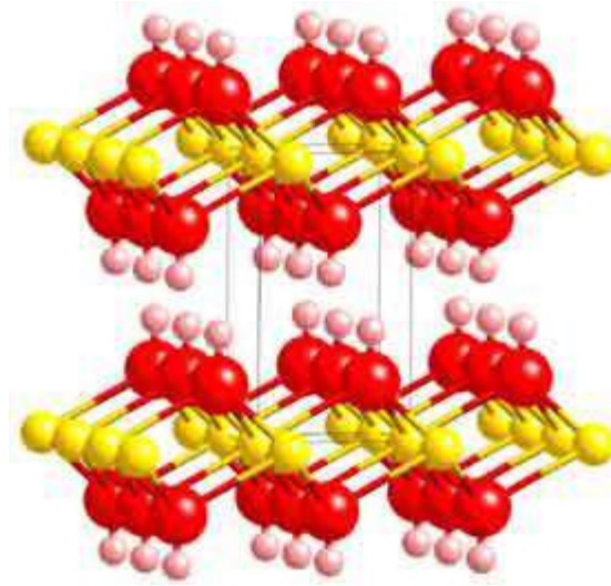
Figure I-1 : Structure de la brucite Mg(OH) 2
