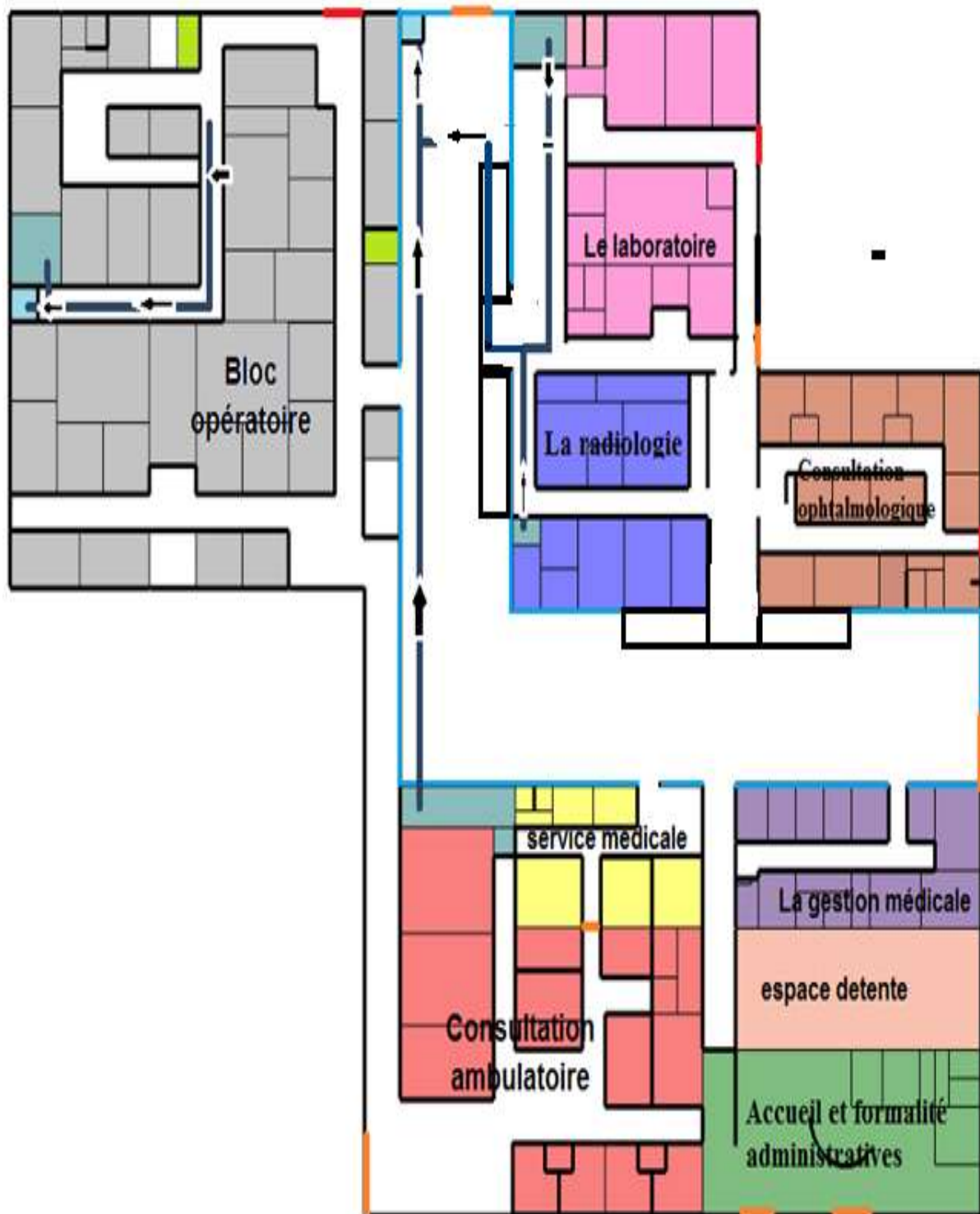
Figure 33: Schéma du circuit du déchet au RDC
