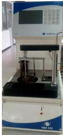
**Figure II.5 :** appareillage de ramollissement.
