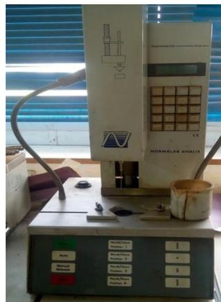
**Figure II.4 :** appareillage de pénétromètre.
